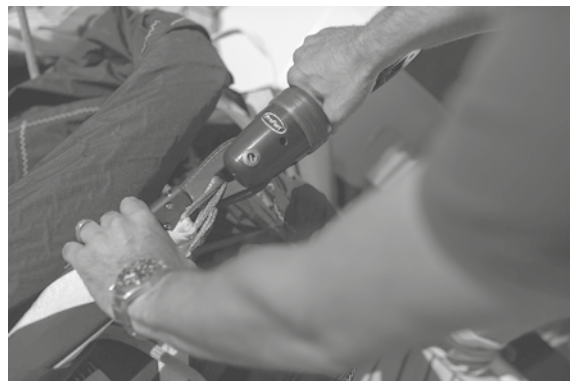
Attacher le point de drisse à l'émerillon Attach the halyard point to the swivel
