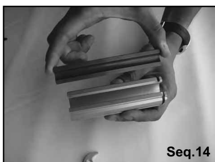
Prendre l'éclisse supérieure. Take the upper bearing holder.
