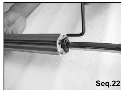
Engager la vis de butée dans la gorge de ralingue et serrer la vis de butée. Fit the stop screw into the luff groove and tighten the top screw.
